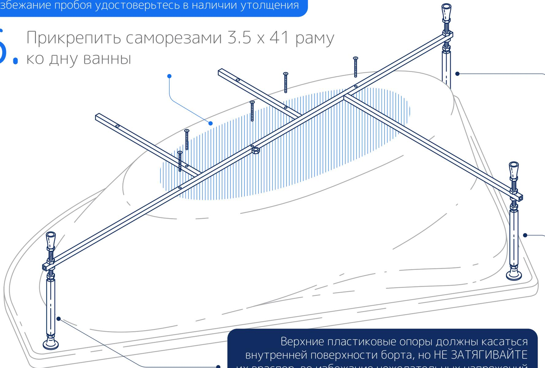
Верхние пластиковые опоры должны касаться внутренней поверхности борта, но НЕ ЗАТЯГИВАЙТЕ их враспор, во избежание нежелательных напряжений в процессе эксплуатации ванны!
