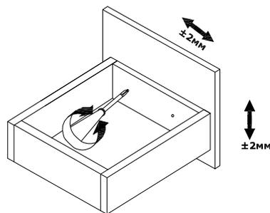
**Регулировка по высоте/ширине с помощью фасадного эксцентрика**
