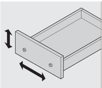
**После регулировки окончательно зафиксируйте положение фасада, вкрутив шурупы из комплекта фурнитуры в соответствующие отверстия в передней стенке ящика.**
