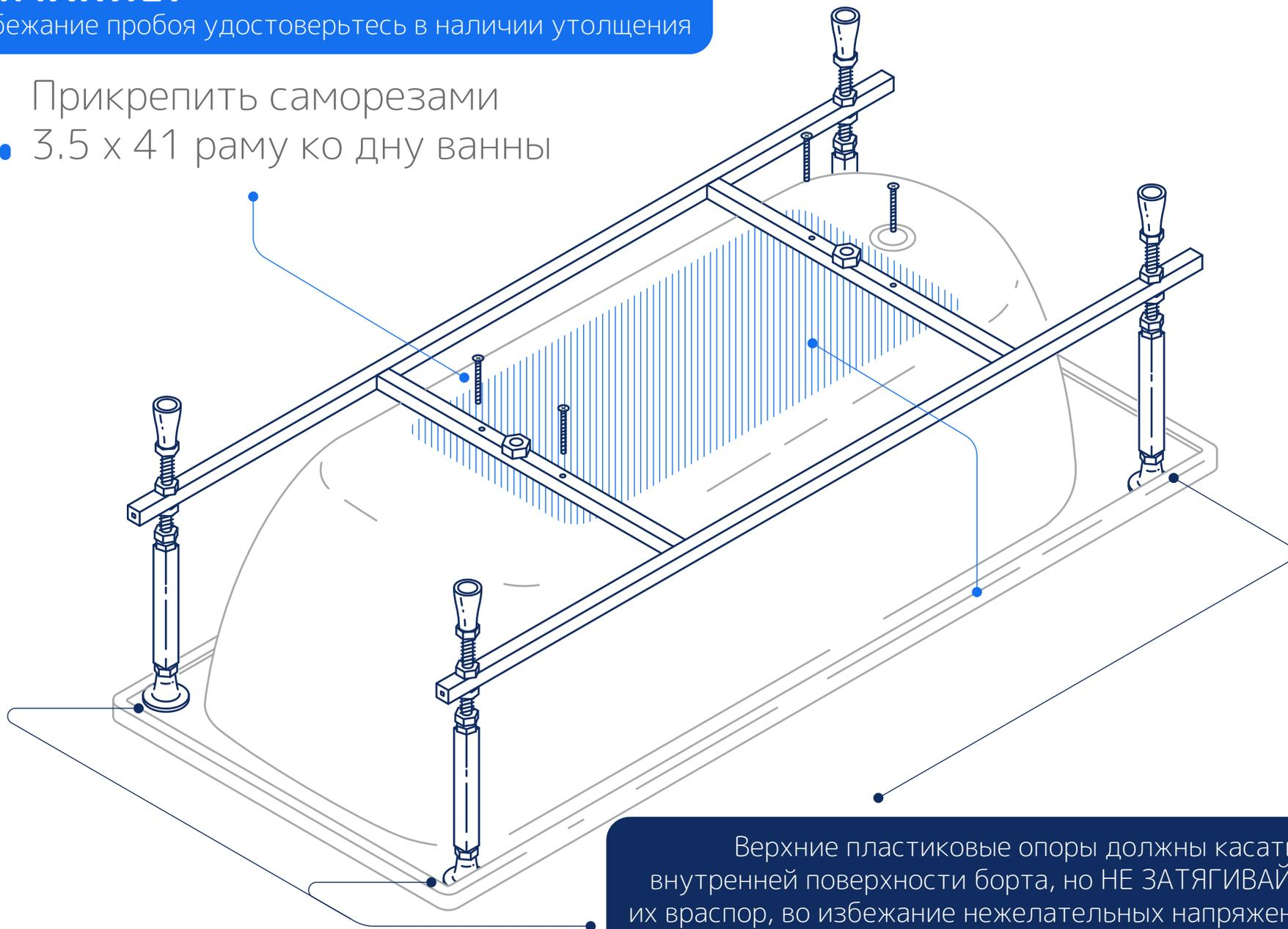
Верхние пластиковые опоры должны касаться внутренней поверхности борта, но НЕ ЗАТЯГИВАЙТЕ их враспор, во избежание нежелательных напряжений в процессе эксплуатации ванны!
