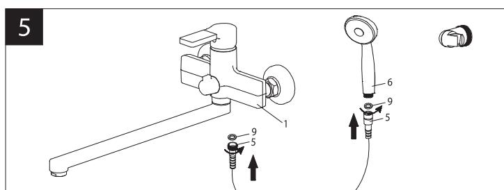
Сразу после установки смесителя необходимо медленно открыть воду на полную мощность и дать ей «протечь» в течение 1 минуты. Пролив нужно выполнить до установки душевой лейки. Перед проливом также рекомендуется снять аэратор (регулятор расхода воды) во избежание его возможного засорения.
