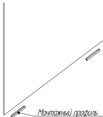
2. Вставьте стекло в профиль ближе к внешней стороне профиля. Ни в коем случае не забивайте стекло по торцевой части, стекло подвержено при таких ударах к разрушению! Вставьте с внутренней стороны профиля уплотнитель елочка. Прижмите уплотнитель равномерно по всей плоскости профиля.
