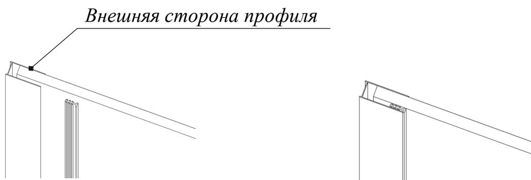
3. Соберите штангу, приложите на стекло и при помощи строительного уровня, обрисуйте на стене элемент крепления штанги. Снимите штангу, сделайте отверстие, уберите мусор. Закрепите элемент крепления штанги. Соберите штангу и затяните все шестигранные винты.
