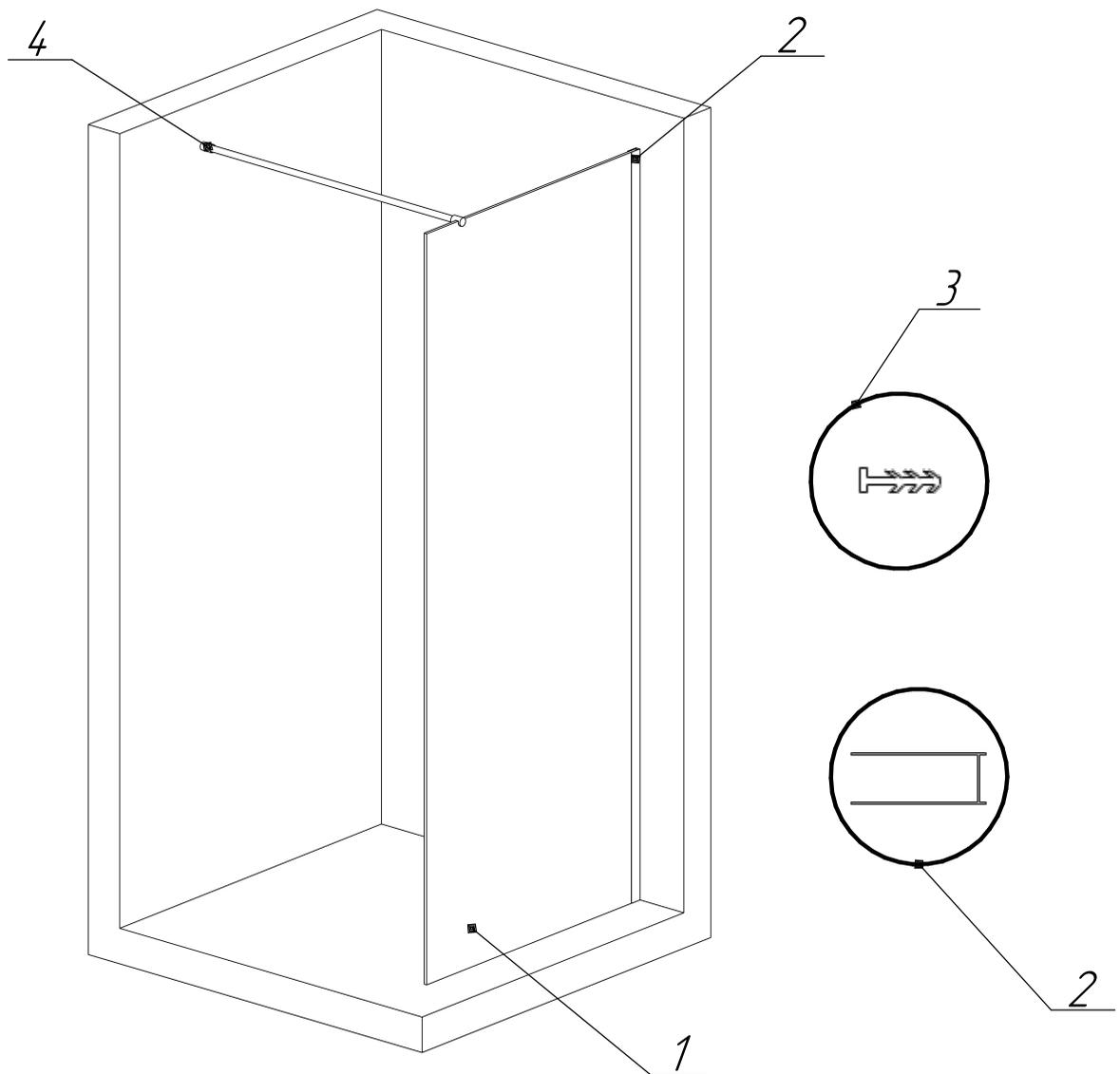
**Обратите внимание, что максимальное расстояние установки перегородки от стены до наружной кромки стекла составляет 1200мм.**
