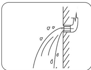
Убедитесь, что все выводы для подключения смесителя подходящего диаметра, размера и имеют идентичную резьбу. Перед установкой тщательно промыть водопроводные трубы, спустив некоторое количество воды.
