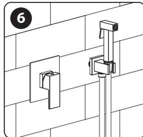
После укладки облицовки снимите защитную крышку и нанесите водостойкий герметик на край плитки.
