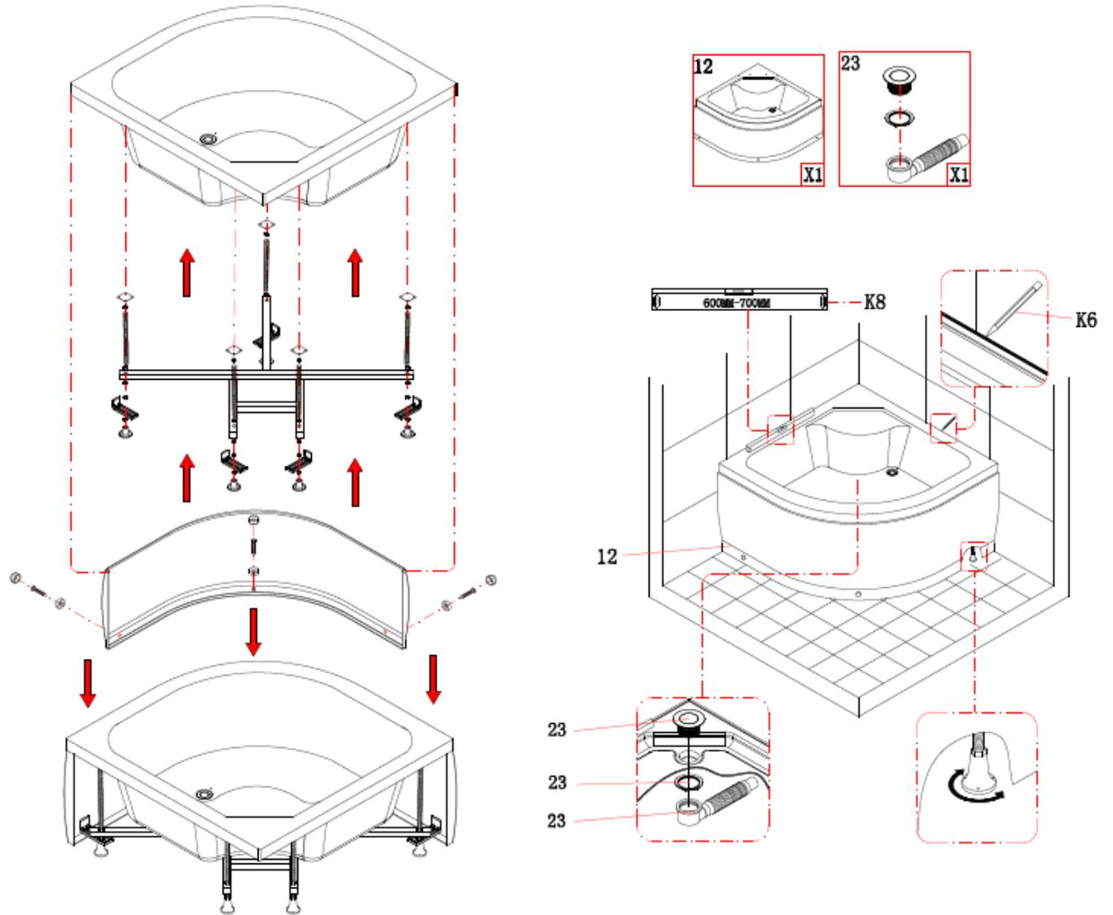
Если поддон с каркасом уже частично собраны , необходимо установить все остальные части предлагающиеся для сборки и протянуть ключом все винтовые соединения. Ножки служат для выставления поддона по уровню , по этому под несущую конструкцию необходимо установить дополнительные опоры.
