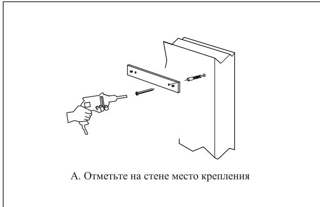
A. Отметьте на стене место крепления
