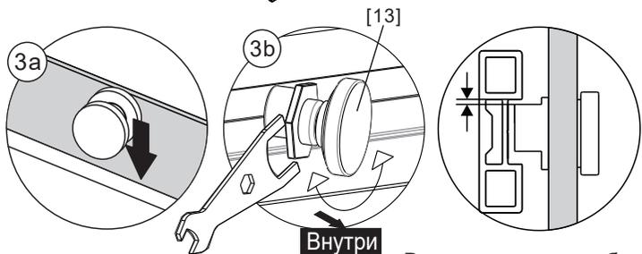
Регулировка должна быть выполнена так, чтобы зазоры были минимальными
