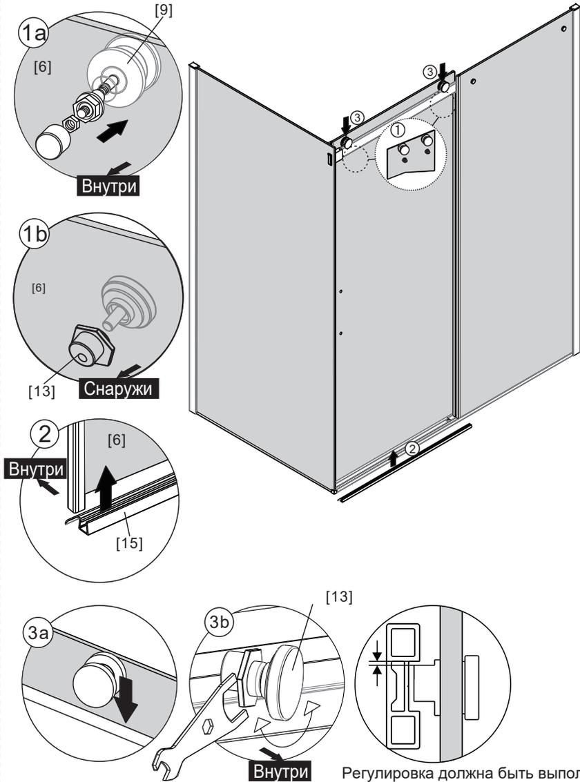
Регулировка должна быть выполнена так, чтобы зазоры были минимальными
