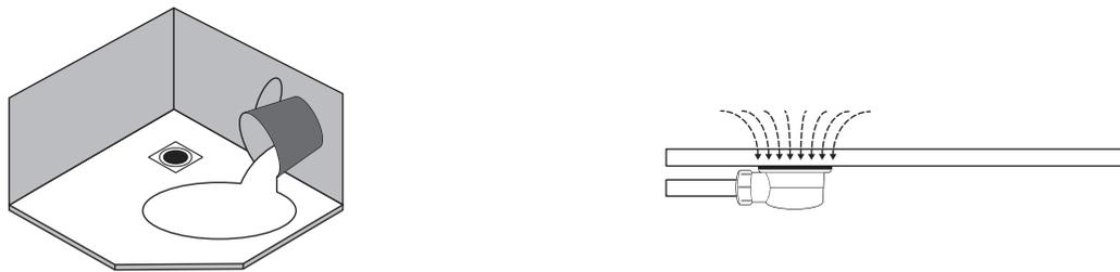
Перед нанесением клея и укладкой, установите душевой поддон на основание и подсоедините сифон. Обильно залейте водой. Убедитесь, что вода течет прямо в канализацию. Эта проверка очень важна. Мы не принимаем жалобы, не производим замену или не возмещаем расходы после установки душевого поддона.
