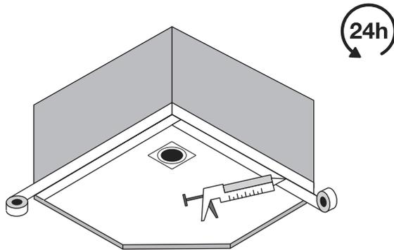
Проклейте душевой поддон малярной лентой перед герметизацией и изолируйте стык между душевым поддоном и стенами с помощью силикона. Дайте высохнуть в течение 24 часов.
