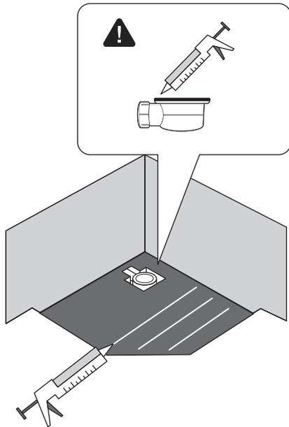
Для установки слива, в целях безопасности, нанесите слой силиконового герметика по периметру резиновой прокладки.
