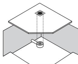
Проверьте соединение между сифоном и сливной трубой, слейте воду и убедитесь в отсутствии протечек.
