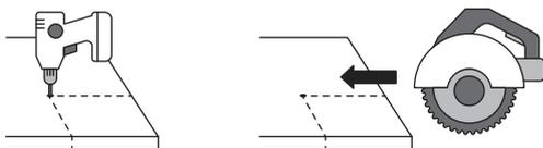
⚠ Для уменьшения размера поддона просверлите отверстие в точке пересечения двух линий, используйте круглый алмазный диск для среза от внешнего края к отверстию, точно следуя линии разреза.
