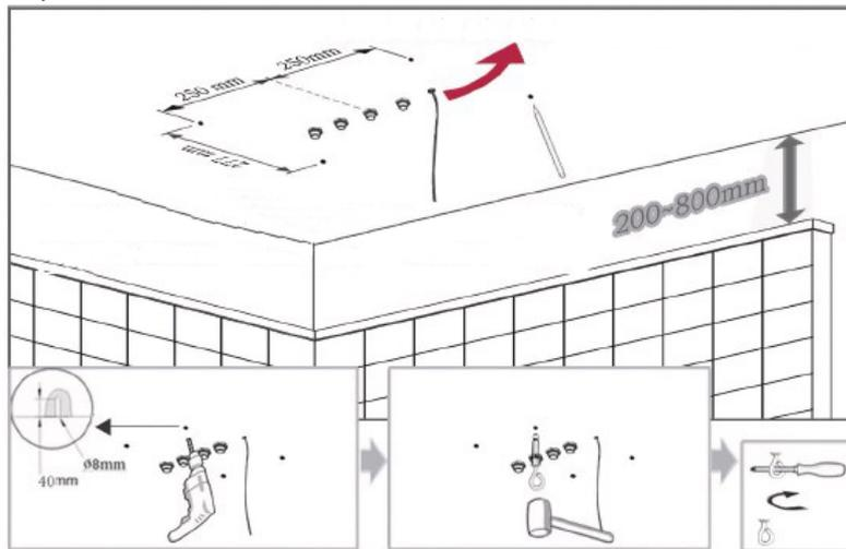
Нарисуйте и просверлите четыре отверстия на потолке. Вставьте пластиковый винт. Поверните винт по часовой стрелке.
