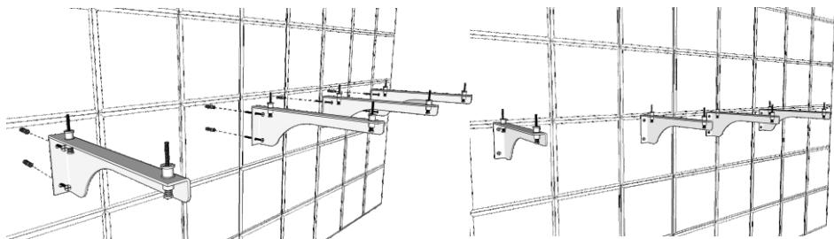
**14.** Положить столешницу на закрепленные кронштейны. Если потребуется, с помощью регулировочных винтов в кронштейнах скорректировать положение столешницы по горизонтали. Предварительно зафиксировать изделие, проставить отметки на стене под металлические уголки, убрать столешницу. Проделать отверстия в стене под уголки, вставить крепеж.
