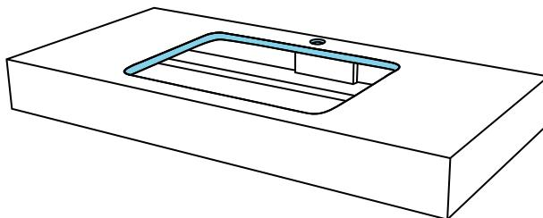
17. Нанести герметик на столешницу с отступом 5 мм от выреза под раковину и отверстия под смеситель. Толщина «валика» герметика около 5 мм.
