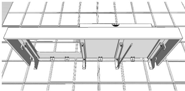
**13.** Отсоединить кронштейны от столешницы, закрепить их к стене на крепеж подходящий под тип материала стены.
