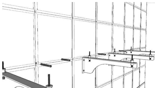
**15.** Положить столешницу на кронштейны. Закрепить через уголки столешницу к стене. Закрепить столешницу к кронштейнам.
