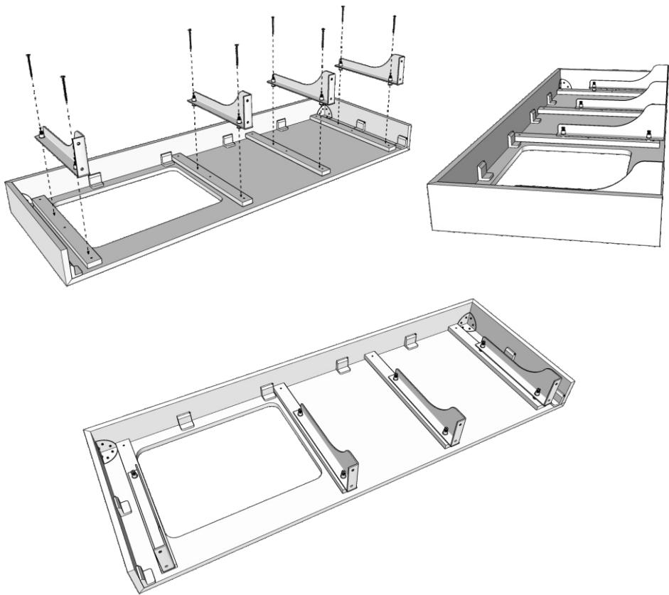
**11.** Для каждой раковины закрепить саморезами 3,5\*16мм два металлических уголка по обеим сторонам отверстия под смеситель по заднему срезу тыльной стороны столешницы, таким образом, чтобы они не помешали монтажу смесителя. При установке одной раковины, оставшиеся уголки распределить равномерно между закрепленными кронштейнами.
