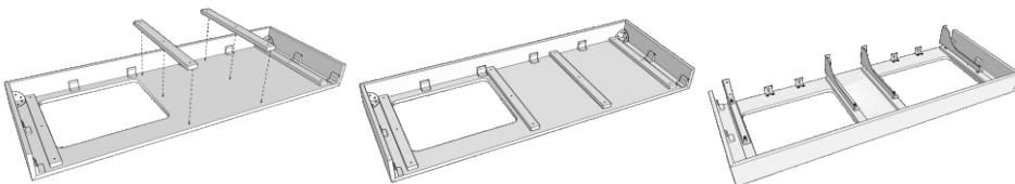
9. В случае использования одной раковины, оставшиеся планки закрепить таким же образом, разместив их через одинаковое расстояние так, чтобы они не мешали подводящим коммуникациям.
