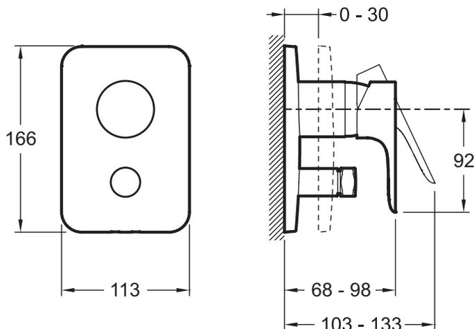
Спецификация продукта: Встраиваемый смеситель с переключателем на 2 выхода, лицевая панель Aleo. E98717. Коллекция: ALEO. Вес: 2,6 кг. Комплектующие: встраиваемый смеситель, заглушки и ручка. Подключение: Подключение к двум выпускным отверстиям (например: верхний душ, ручной душ, излив для ванны).
