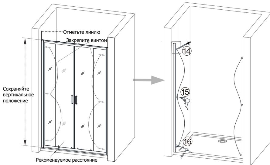
I-1) Вставьте, пожалуйста, алюминиевую раму в душевой угол с одной и с другой стороны, затем установите ее в нужное место и сделайте карандашом отметку где необходимо высверлить отверстия для фиксации. Затем выньте алюминиевую раму, просверлите отверстия в стене, вставьте в них дюбеля и зафиксируйте раму к стене винтами (ST4x25).
