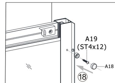
1-2) В завершении, установите душевой угол в отмеченное место, затяните винты и соедините внешний и внутренний профиль, после чего наденьте на винт декоративный колпачок.
