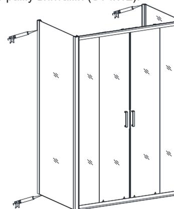
\* При желании, места соединения можно обработать водонепроницаемым составом (силиконовым герметиком) с каждой стороны. В этом случае не используйте душевой угол в течение 24 часов, чтобы дать возможность силиконовому герметику высохнуть.
