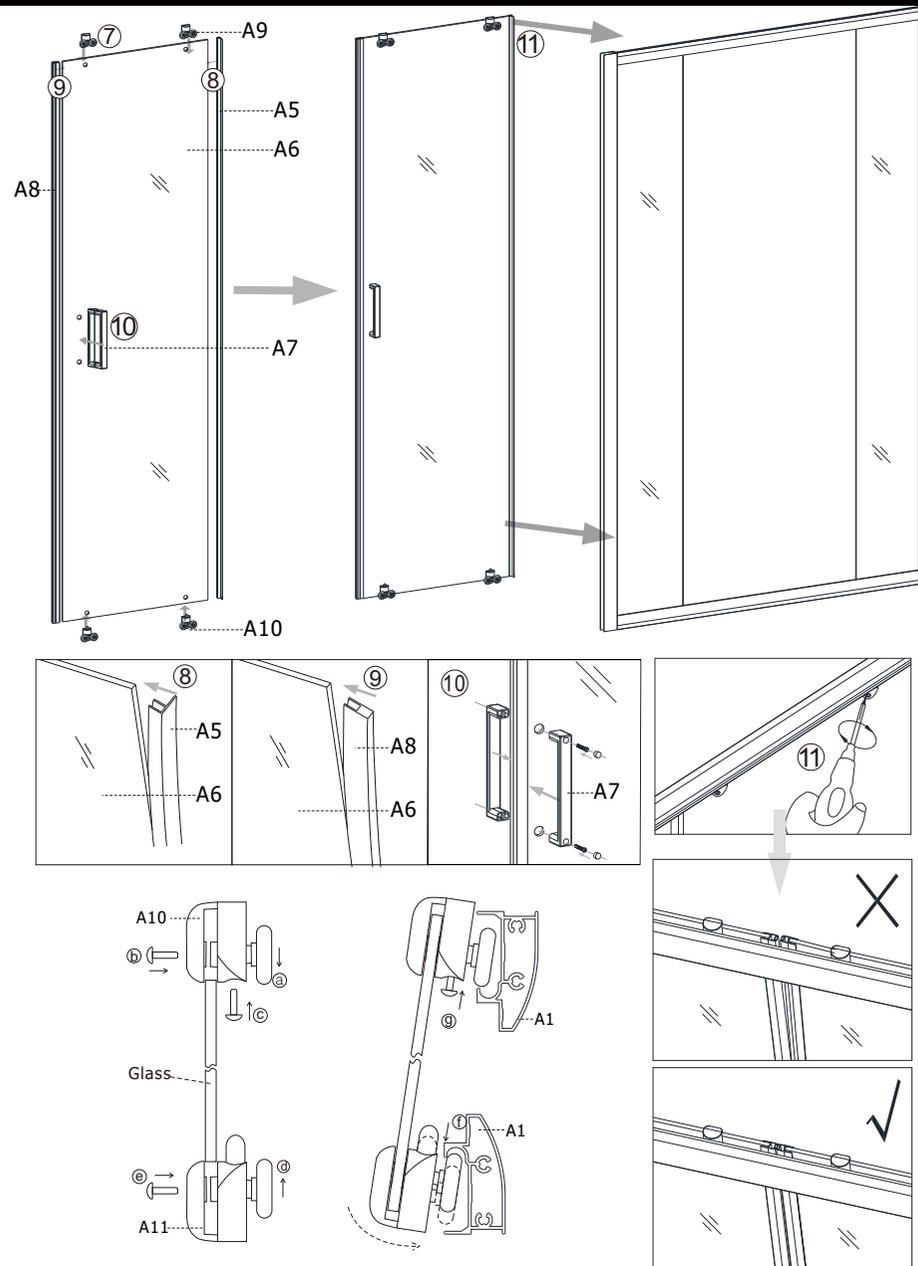
3.1) Закрепите ролики на раздвижной стеклянной двери, отрегулируйте дверь. Установите водонепроницаемые уплотнители и магнитные уплотнители. 3.2) Установите раздвижную дверь на направляющий профиль. Отрегулируйте винт на роликах для правильного хода раздвижной двери.
