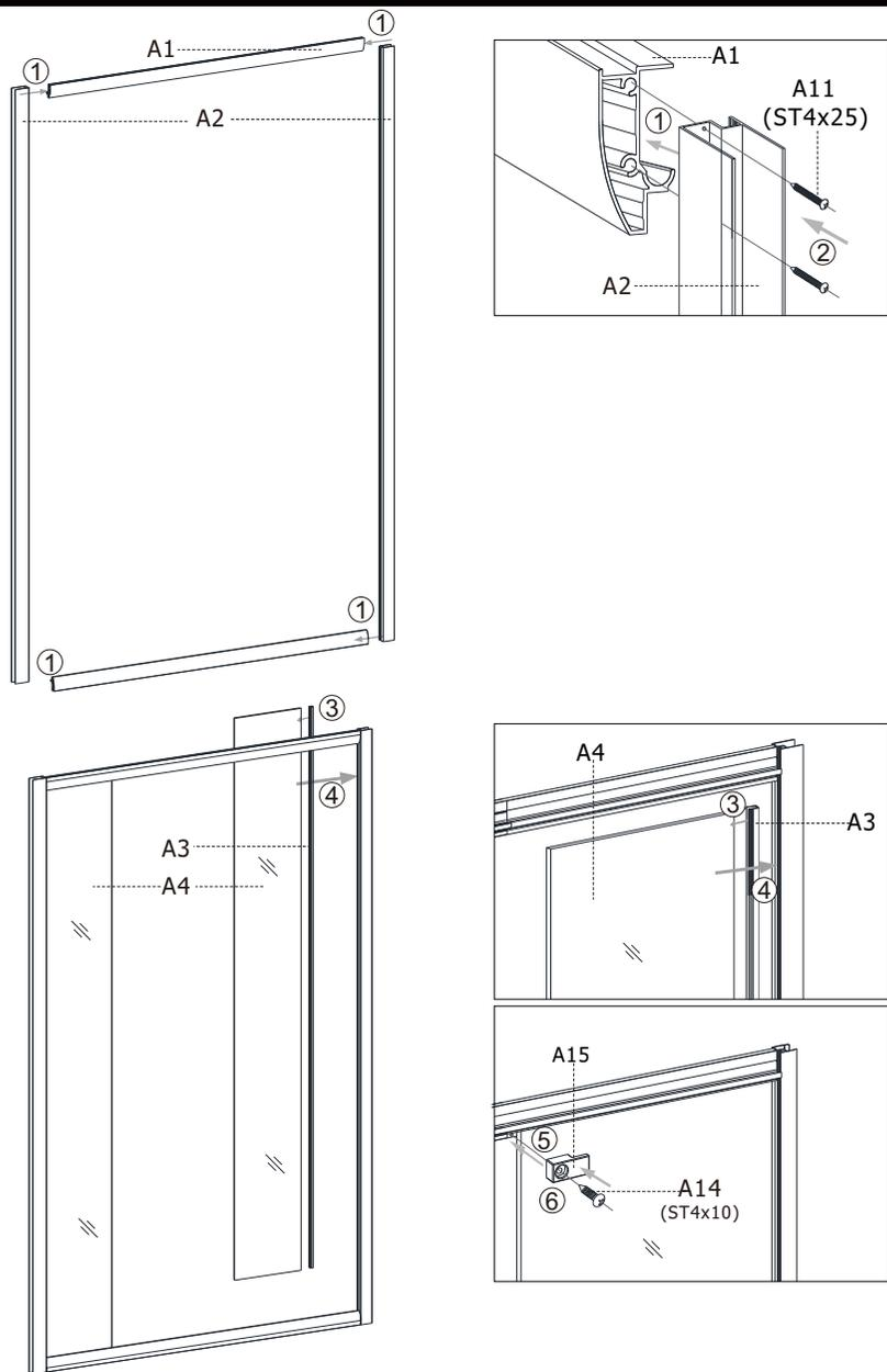
2.1) Закрепите алюминиевую раму в верхний и нижний пазы с помощью винта A13 (ST4x25). Наденьте U-образный уплотнитель на неподвижное стекло и вставьте его в алюминиевый профиль. Затем закрепите стекло с помощью фиксатора неподвижного стекла (A15).
