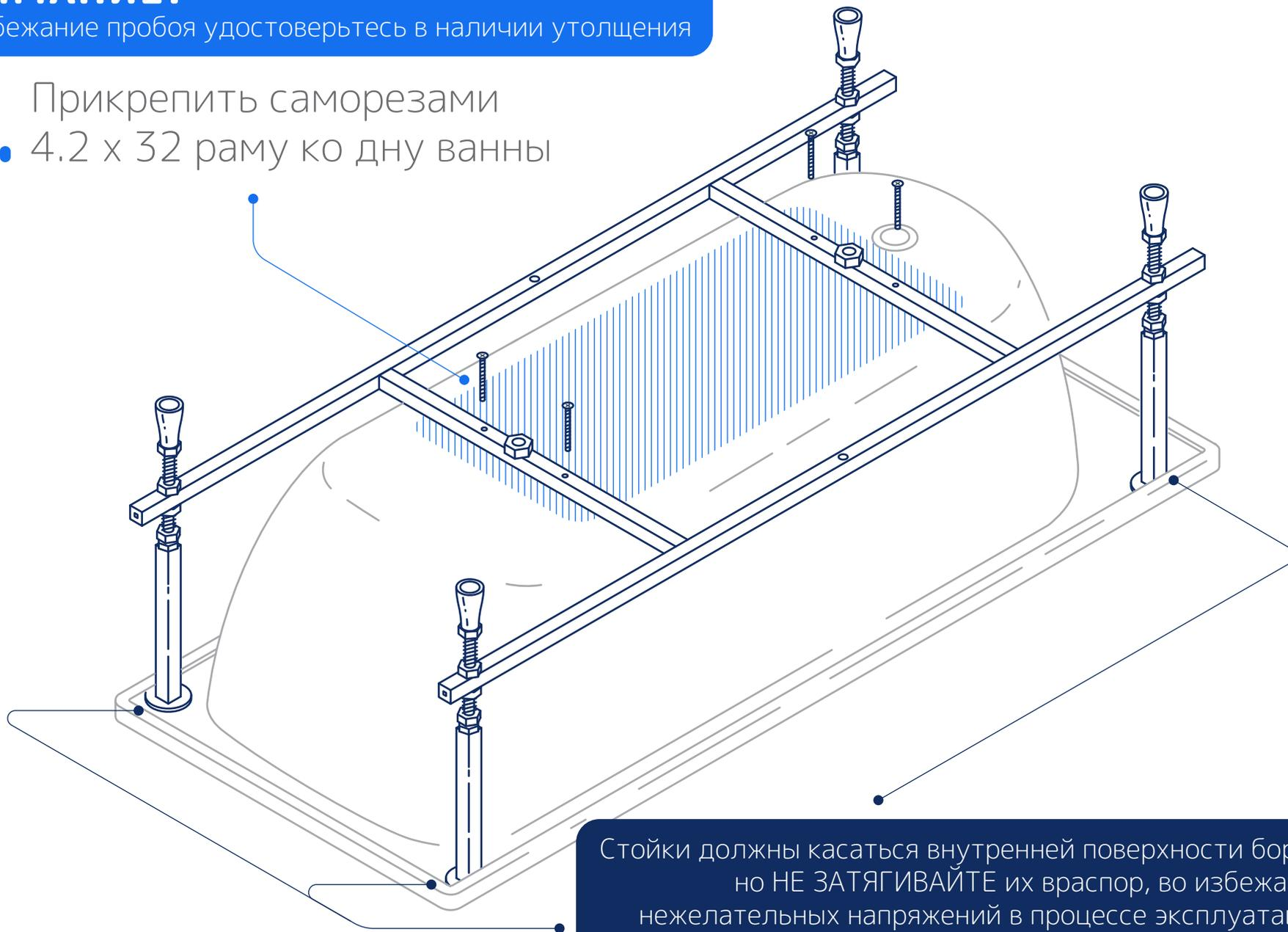
Стойки должны касаться внутренней поверхности борта, но НЕ ЗАТЯГИВАЙТЕ их враспор, во избежание нежелательных напряжений в процессе эксплуатации ванны!
