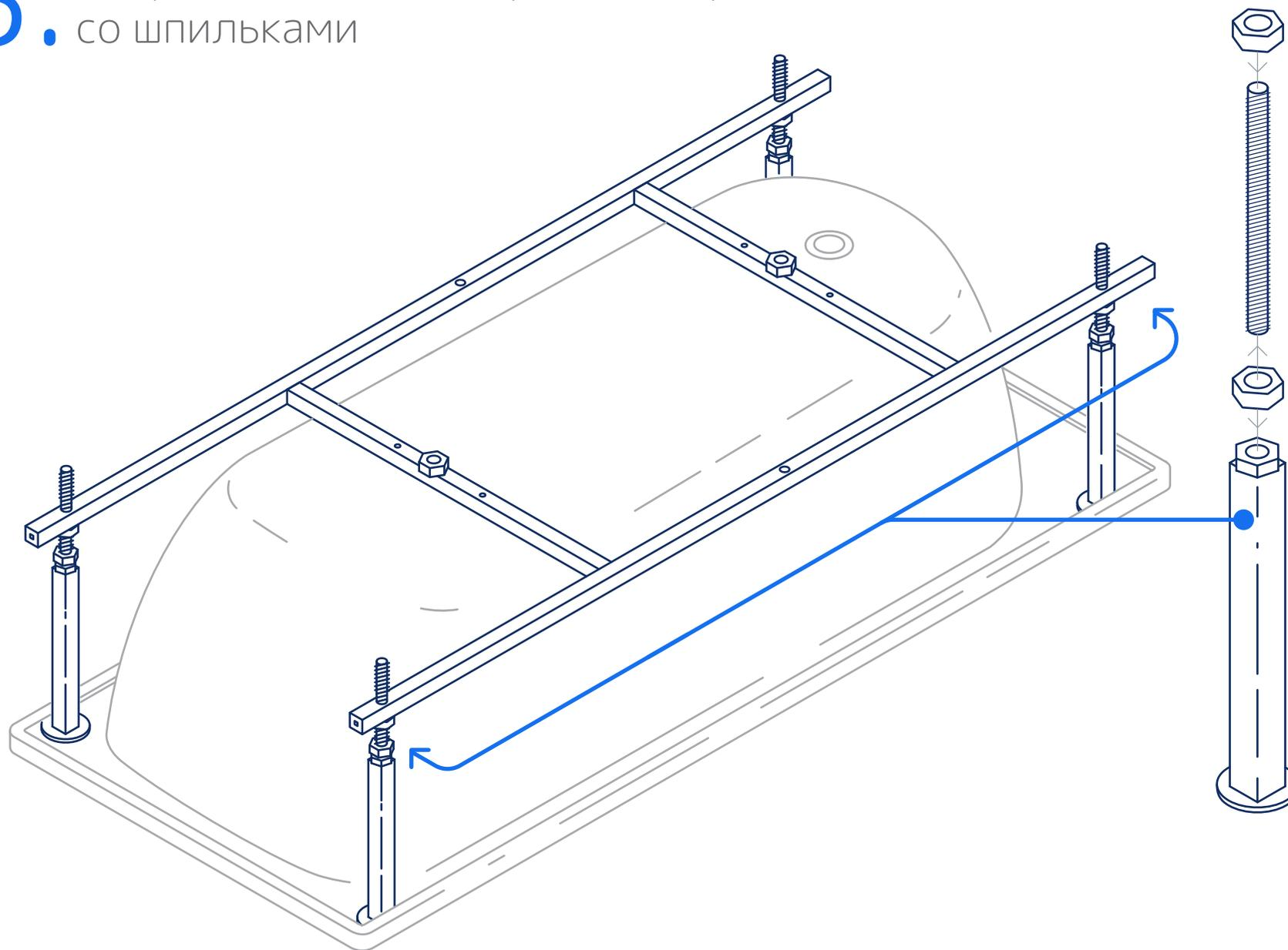
4. Установить нижние опоры с гайками на шпильки
