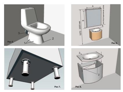
Прикрепить тумбу к стене при помощи кронштейнов, навесов или технологических отверстий. Нанести силиконовый герметик в местах примыкания раковины к тумбе и к стене. Установить и выровнить раковину на тумбе.
